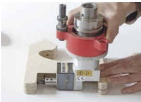
... passt in die Ausklinkung für die Stufe und bohrt beide Richtungen
