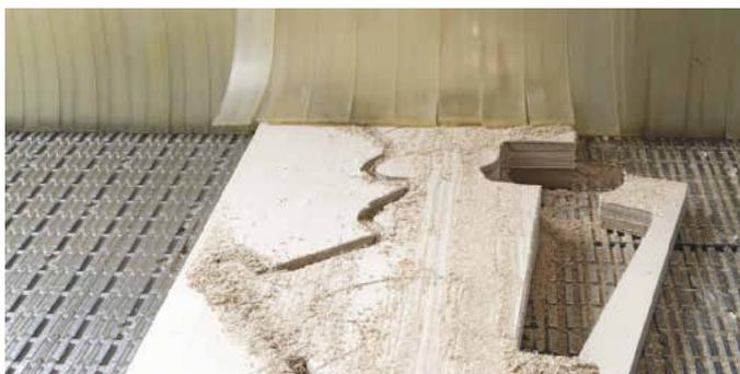
Fertigen der Wangenelemente auf der CNC: In der Prototypenphase gingen die Teile danach zur Langlochbohrmaschine
