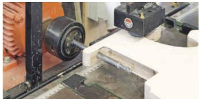
Beim herstellen der Prototypen fehlte Material, in dem der Bohrer Halt fand. Die Folge waren Einbußen an Präzision
